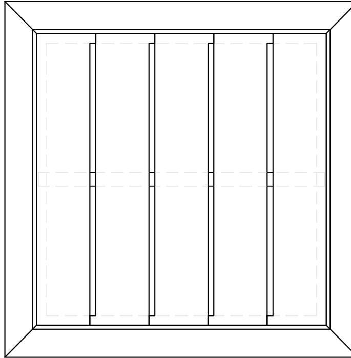
Le doghe sono appoggiate e facilmente rimovibili per la pulizia dello scarico sottostante.
